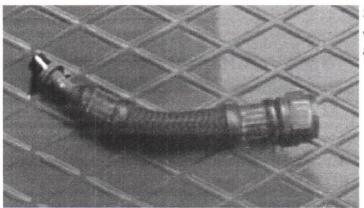
Schlauchleitung, welche vom Motor zur Steigleitung führt kpl. ausbauen.
