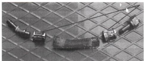
Metallmuffen mittels Säge o.ä. einschneiden, Schlauch von den Endstücken abziehen.
