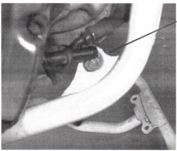
Anschluß schräg nach unten drehen, Motorhalterung evtl. mittels Rundfeile bearbeiten um der Schlauchleitung mehr Platz zu verschaffen.
